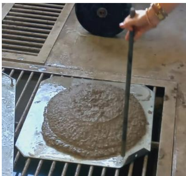
Figura 9 - Slump-flow test realizado em um concreto pouco fluido, antes de adicionar o superplastificante.
