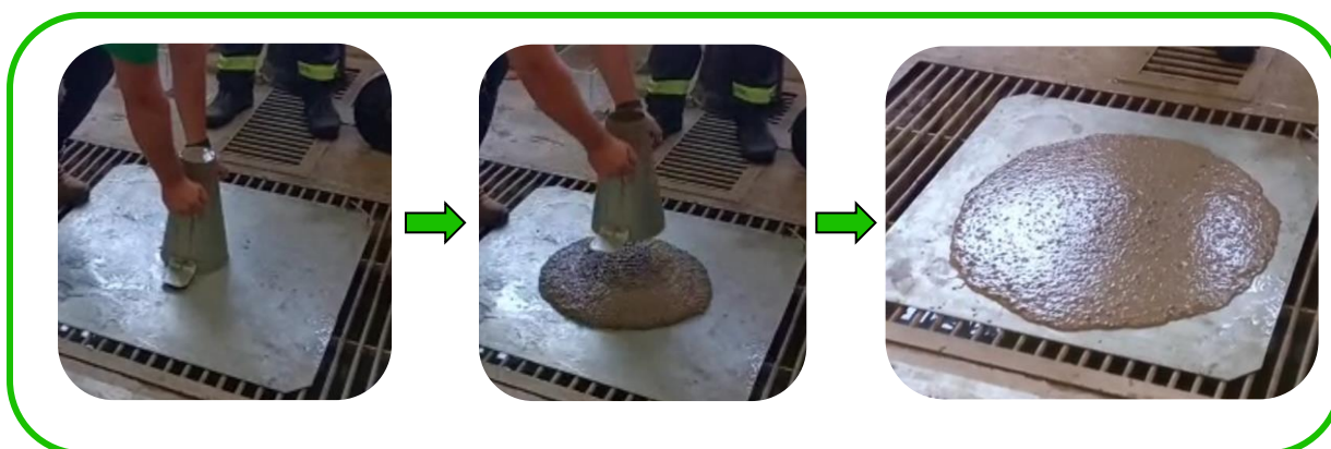
Figura 10 - Slump-flow test realizado em um concreto autoadensável.
