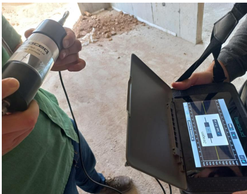
Figura 36 -- Realização da calibração do aparelho de ultrassom.
