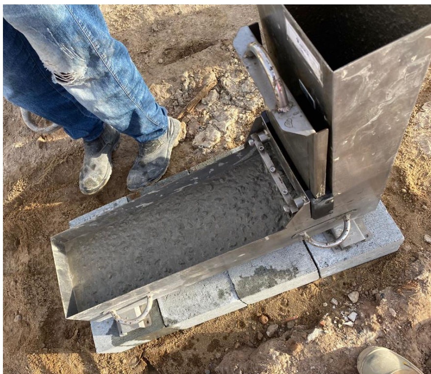
Figura 31 - Realização de ensaio de caracterização (caixa L), antes do lançamento do concreto (1º dia).
