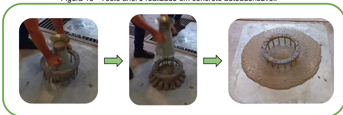
Figura 15 - Teste anel J realizado em concreto autoadensável.
