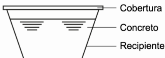
Figura 24 - Configuração do recipiente após o enchimento de concreto
