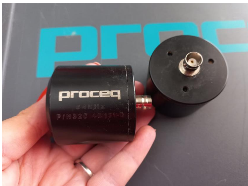
Figura 35 – Transdutores de 54 kHz, do ultrassom Pundit, utilizados no ensaio.
