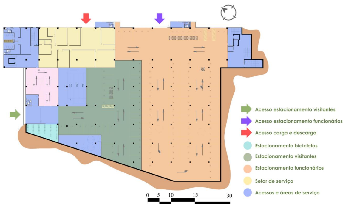
Figura 127- Planta de subsolo
