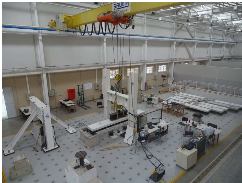
Figura 57: Laje de reação.
