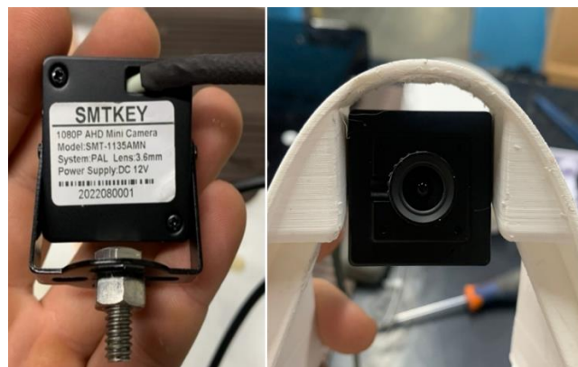
Figura 10 – Minicâmera SMT-1135AMN com haste e parafuso para acoplamento no manequim do simulador e cabo para conexão com DVR e com monitor LCD
