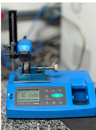
Figura 07 – Rugosímetro utilizado para a avaliação da rugosidade superficial das amostras. Ceará, 2026.
