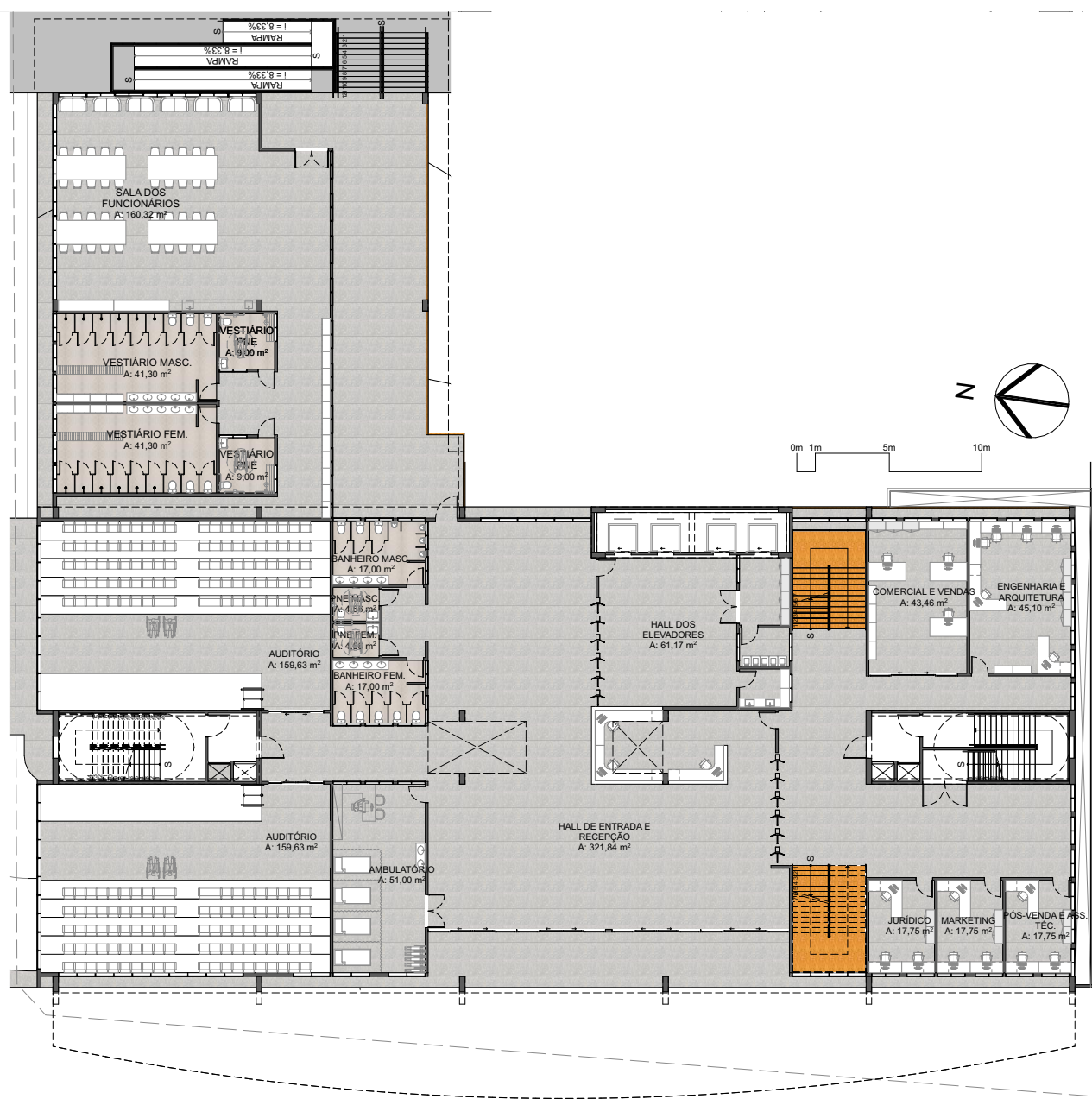
Figura 89 – Edifício Educacional - Planta Baixa do Pavimento Térreo.
