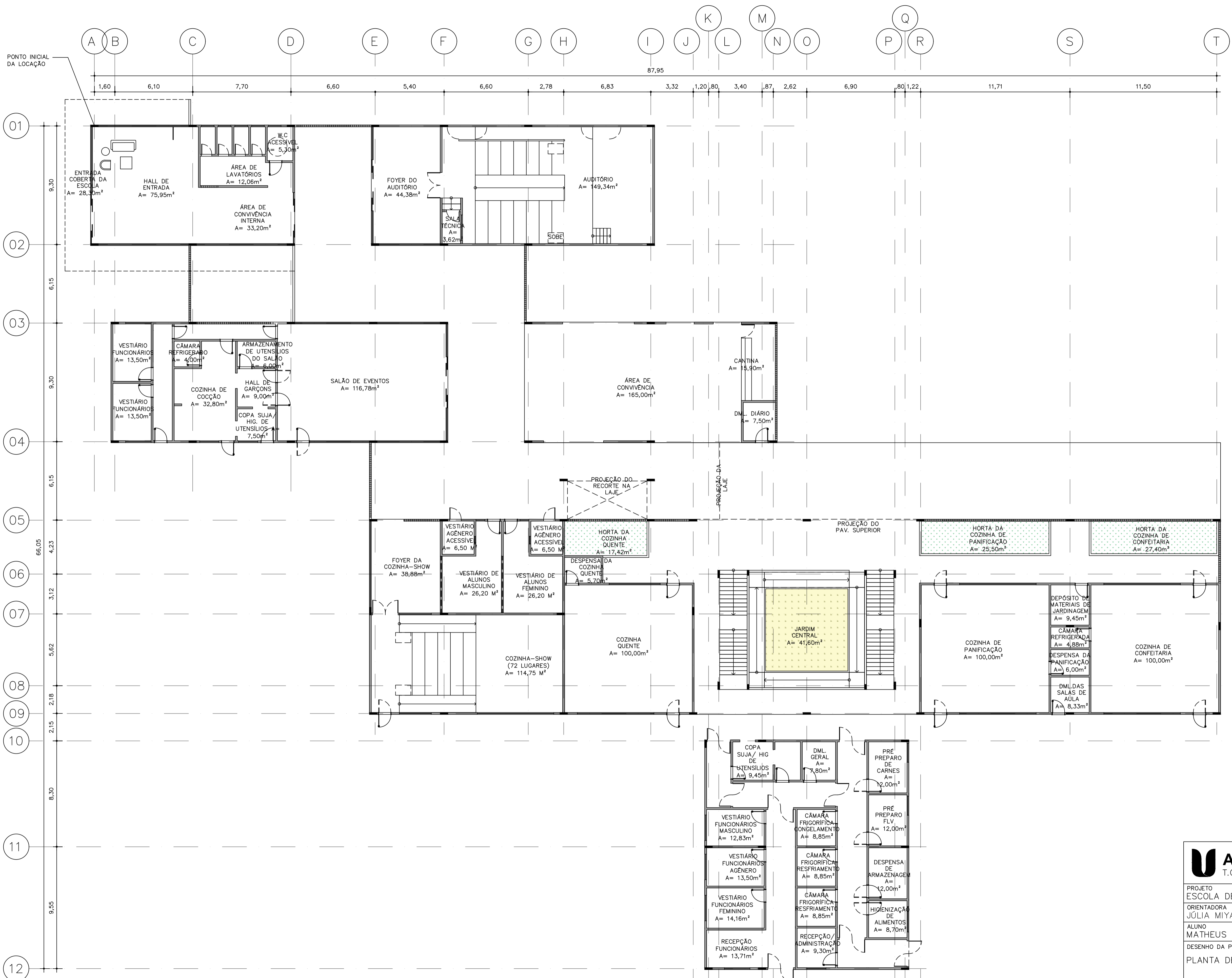
01 PLANTA DE LOCAÇÃO DE EIXOS ESTRUTURAIS ESCALA: 1/150
