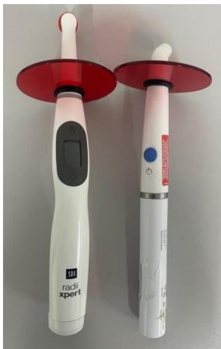
Figura 8 – Fotopolimerizadores utilizados no estudo.
