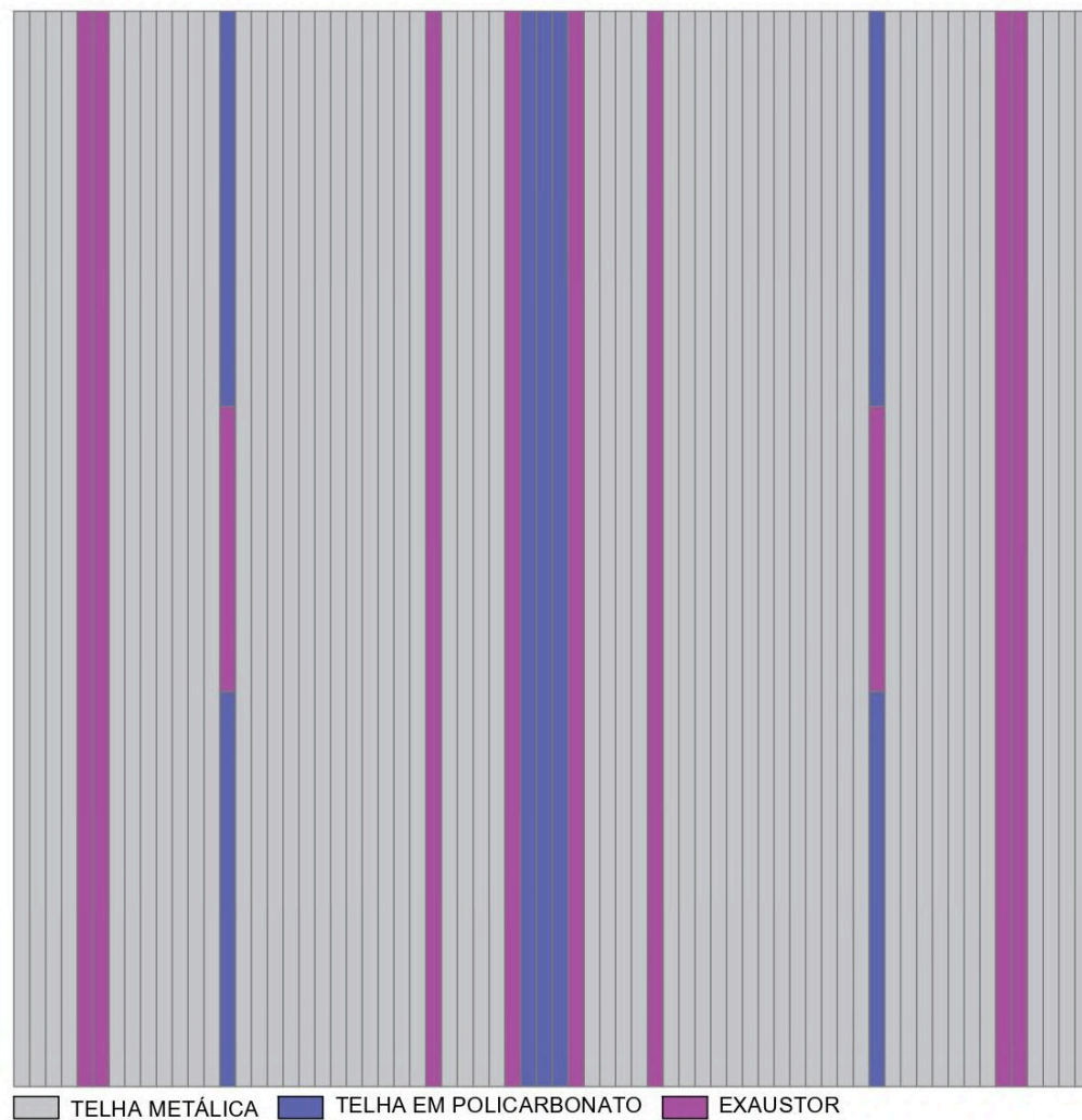
Figura 89 - Distribuição das diferentes telhas no telhado.
