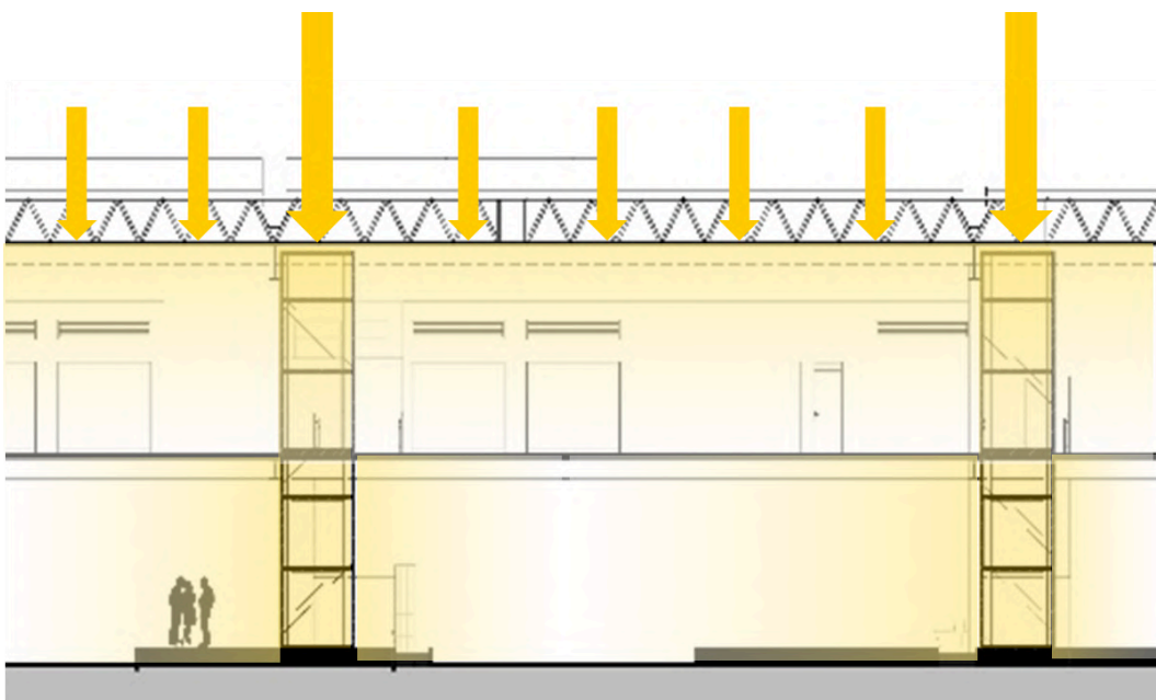
Figura 90 - Entradas para a iluminação natural.
