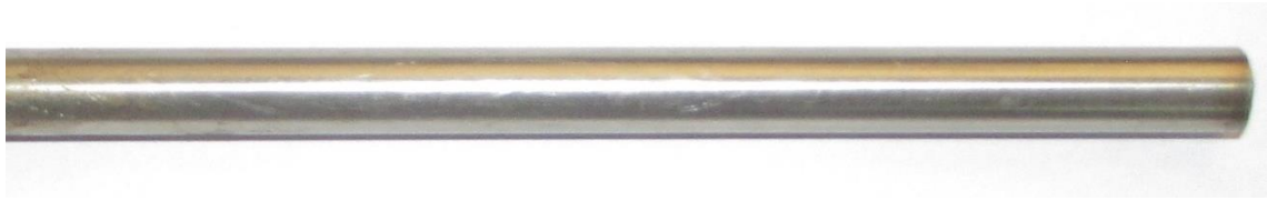
Figura 17- Aço inoxidável 304 utilizado para o desenvolvimento do protótipo.
