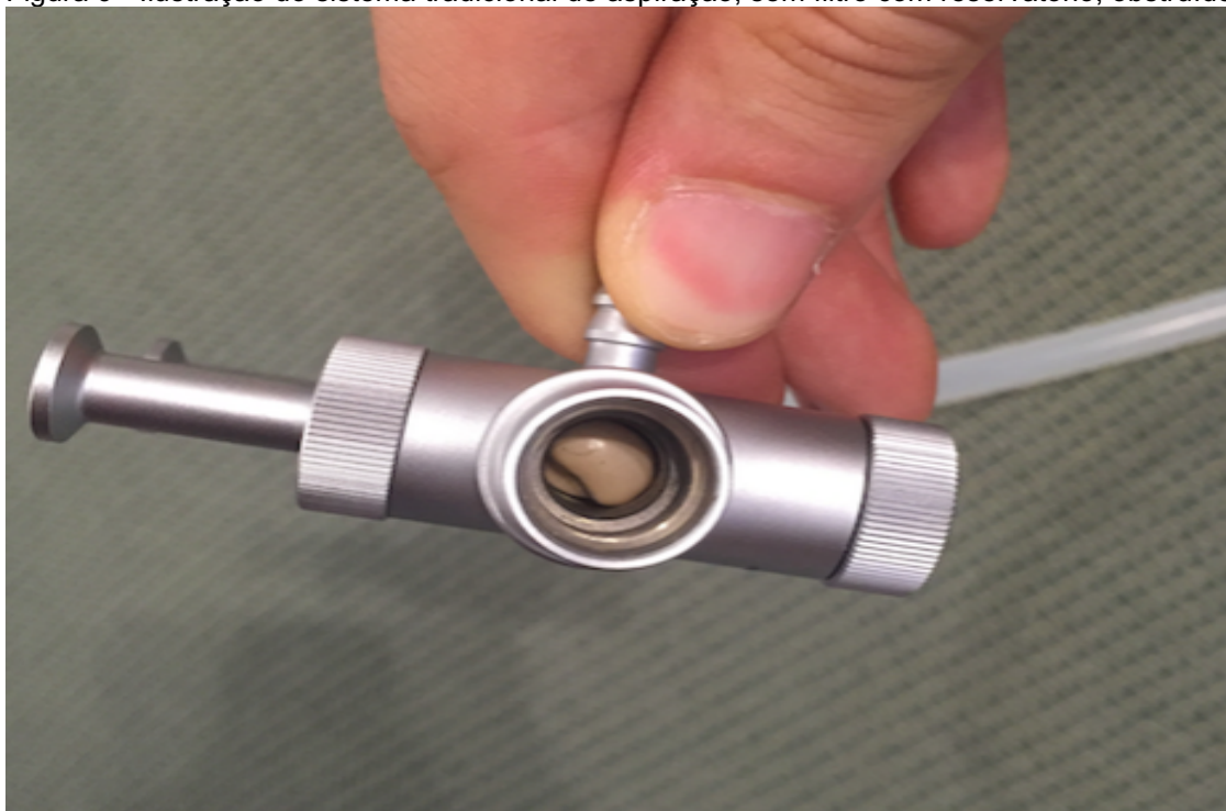
Figura 9 - Ilustração do sistema tradicional de aspiração, sem filtro com reservatório, obstruído.
