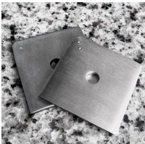
**FIGURA 1:** Dispositivos de aço de 2mm de espessura com medidas de 4x4cm, contendo círculos concêntricos de 5mmØ x 2mm.
