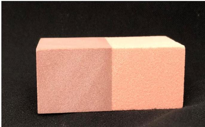
**Figura 2.** Corpo de prova de Poliuretana Synbone<sup>®</sup> utilizado no estudo.
