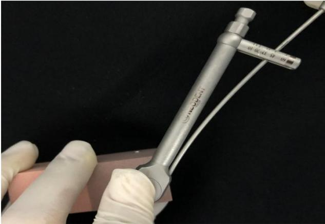
**Figura 5.** Teste de inserção, utilizando catraca manual.
