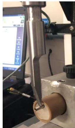
**Figura 7.** Ponta aplicadora de força.
