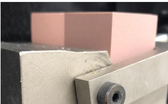
**Figura 3.** Base para fixação do corpo de prova.
